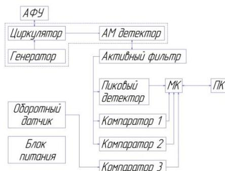
Рис. 1. Структурная схема экспериментального устройства
