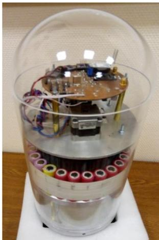
Рис. 1. Подводный погружной робот
