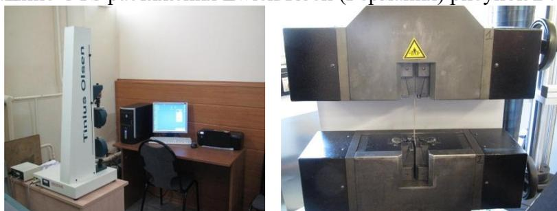
Рис. 2. Испытательные машины Tinius Olsen и UTS Zwick/Roell
