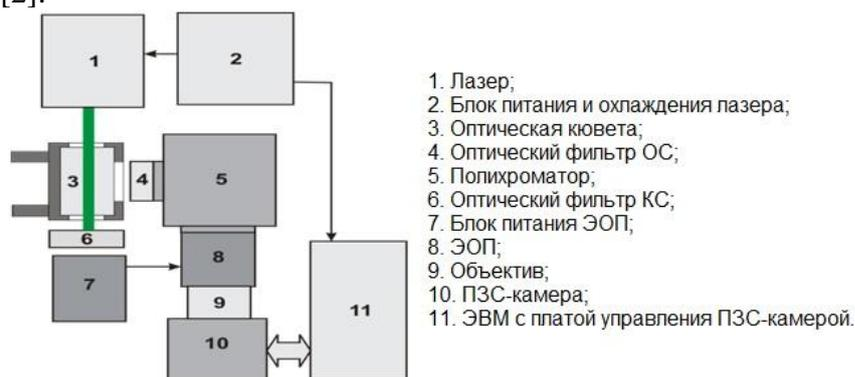
Рис. 1. Оптическая схема установки ЛИФ [2]
