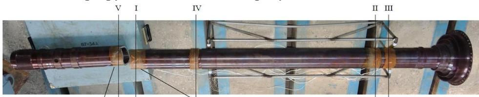
Рис. 3. Вал ТНД после циклического разрушения
