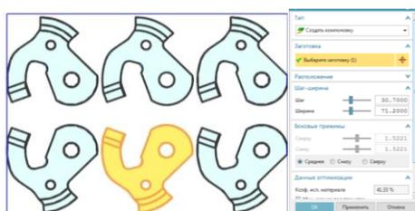
Рис. 2. Компоновка заготовки
