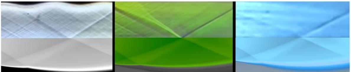
Рис.2 Изображено наложение эксперимента и контуров ANSYS, с разными типами заливок, настроенными в модуле CFD-Post. Наверху эксперимент, внизу модель.
