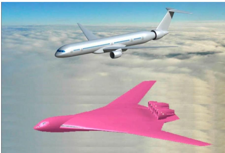
Рис. 5. Модель самолета с распределенной силовой установкой
