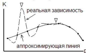
Рис. 3. Ошибка оценки глобального максимума оптимизируемого критерия при недостаточной дискретизации области аппроксимации
