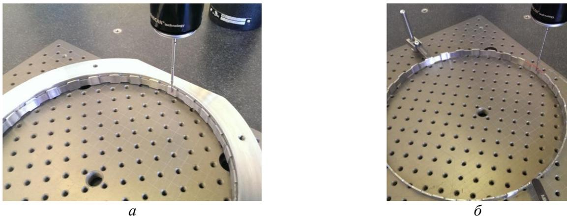
Рис. 2. Измерение геометрии деталей для экспериментов а – сборка внешнего и фигурного кольца; б – фигурное кольцо в свободном состоянии
