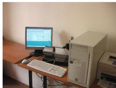
Рис. 2. Профилограф-профилометр БВ-7669
