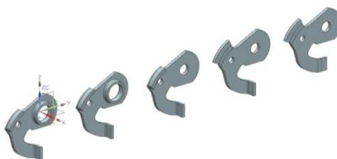
Рис. 3. Последовательность операций штамповки
